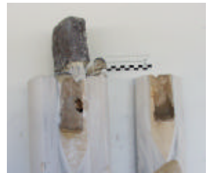
Innenansicht einer Dübelverankerung
